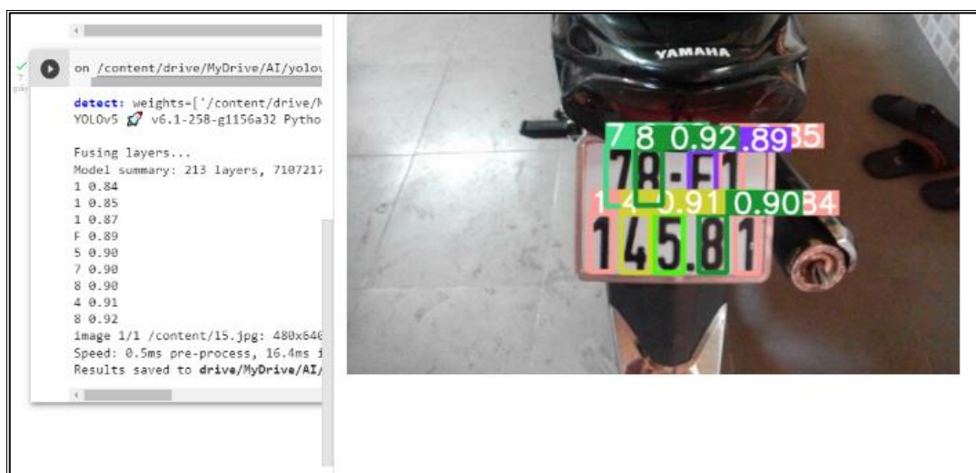
Hình 2.12: Kết quả kết hợp nhận diện vùng biển số và phân tách các ký tự
